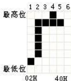
用户定义的字符储存在 RAM 内，断电后将会丢失，如果许多 ESC & 命令使用同一个 m 值，只有最后一个有效。最多可以定义 32 个用户自定义字符。参见 ESC % 和 ESC : 命令。
