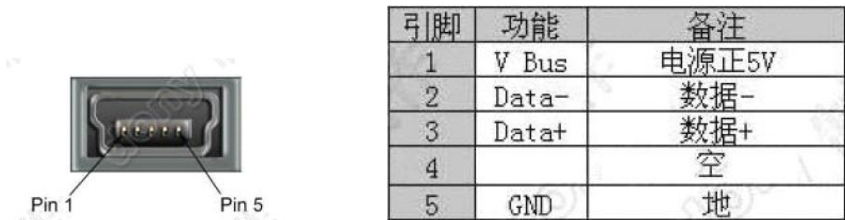
图 2-5 Mini-USB 插座及引脚定义
