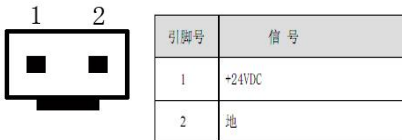
图 2-7 电源插座及引脚定义
