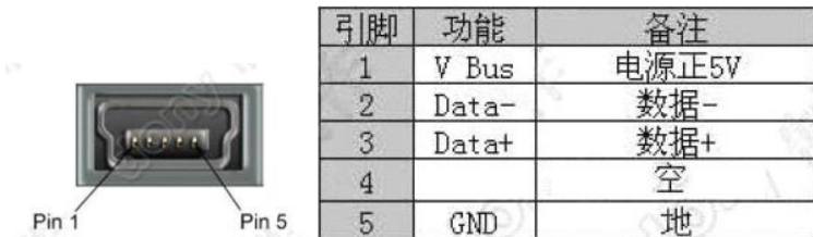
Mini-USB 插座及引脚定义
