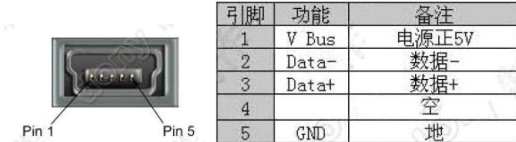
图 2-5 Mini-USB 插座及引脚定义
