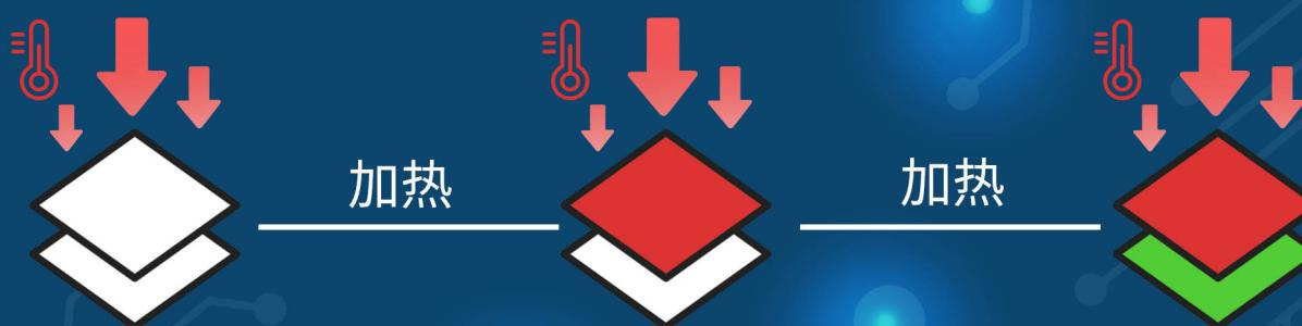
例如，低熔点层显红色，高熔点层显绿色，那么热敏纸就显黑色。
