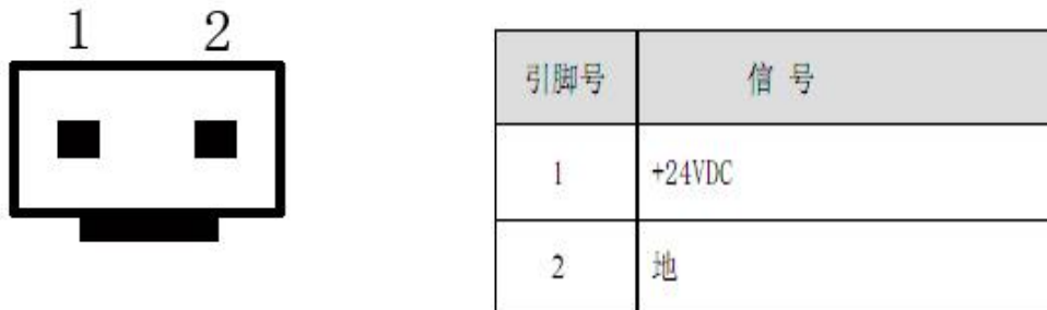
图 3-7 电源插座及引脚定义
