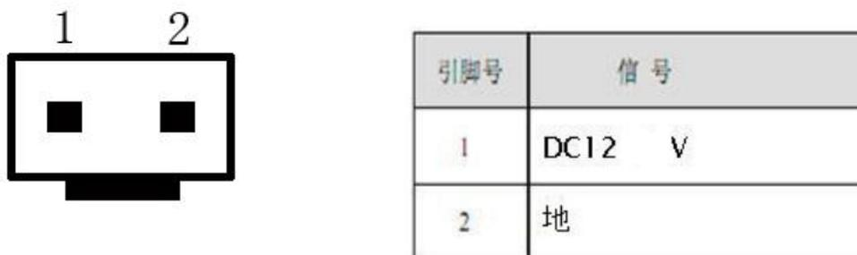
图 2-6 电源插座及引脚定义
