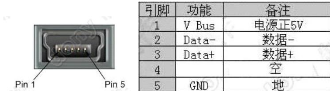
图 3-10 Mini-USB 插座及引脚定义
