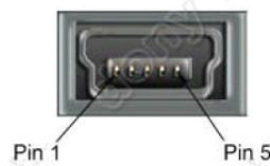
图3-3 USB接口插座引脚序号
