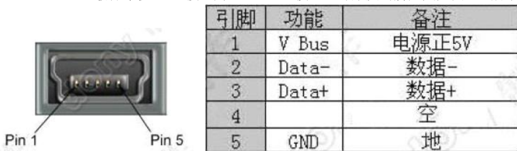
图 2-5 Mini-USB 插座及引脚定义
