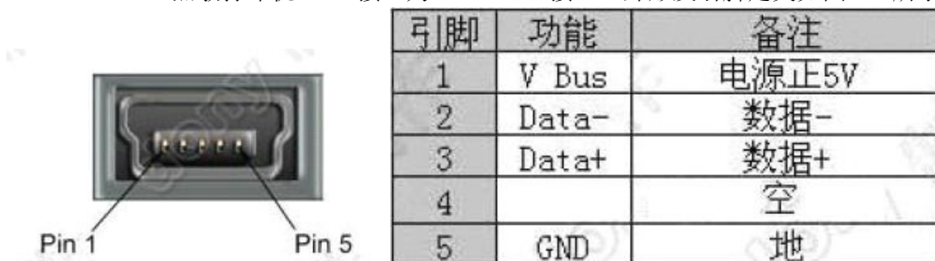
图 2-5 Mini-USB 插座及引脚定义
