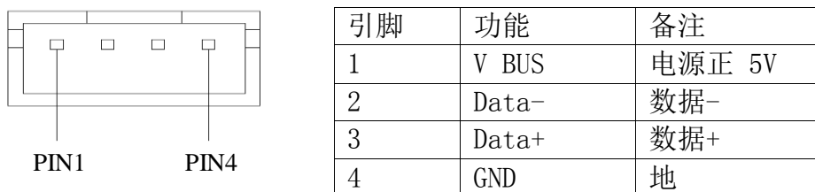
图 2-5 USB 插座及引脚定义
