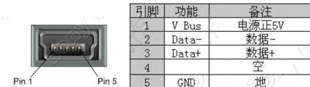
图 2-6 Mini-USB 插座及引脚定义
