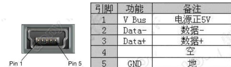
Mini-USB 插座及引脚定义
