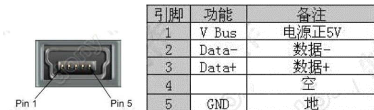
Mini-USB 插座及引脚定义
