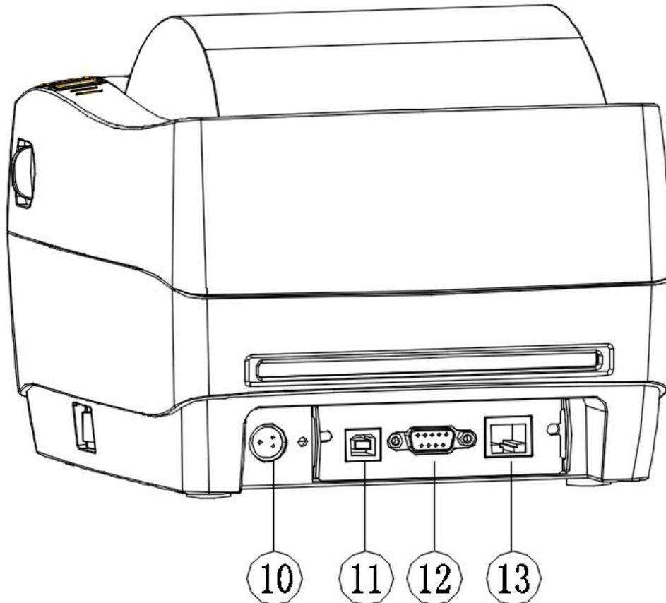
1.走纸键 2.暂停键 3.错误灯 4.电源灯 5.透明仓 6.上壳体 7.开门按键 8.下壳 9.电源开关 10.电源接口 11.USB 接口 12.DB9 串口 13.网口
