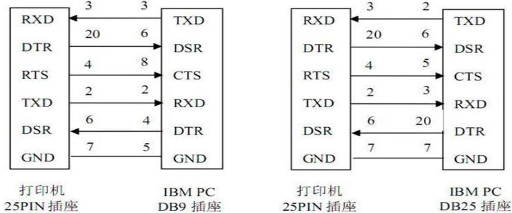
图 2-6 打印机串行接口与 PC 机串行接口连接示意图
