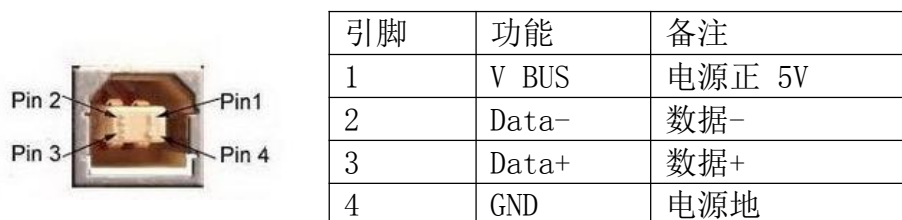
图 3.3-1 USB 插座及引脚定义
