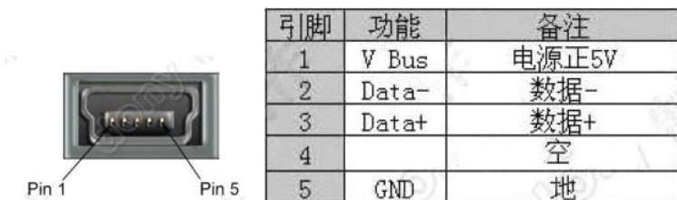
Mini-USB 插座及引脚定义
